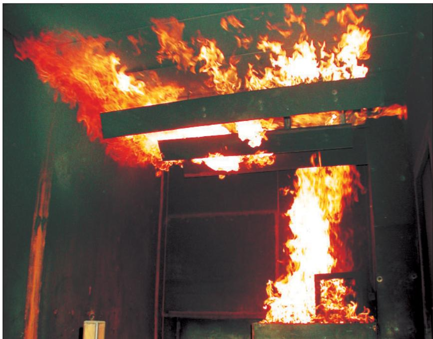
**Flash-over-Simulator: In solchen Übungsanlagen entstehen über kurze Zeit sehr hohe Temperaturen**
