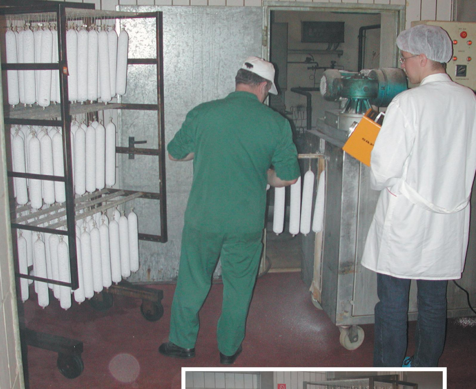
wird und die beaufschlagten Gelatrefilter aufgelöst und danach verschiedene Verdünnungsstufen auf Malzextrakt aufgebracht werden. Anschließend entwickeln sich durch Bebrütung bei 25 °C die Pilzkolonien und können nach drei bis sieben Tagen ausgewertet werden.
