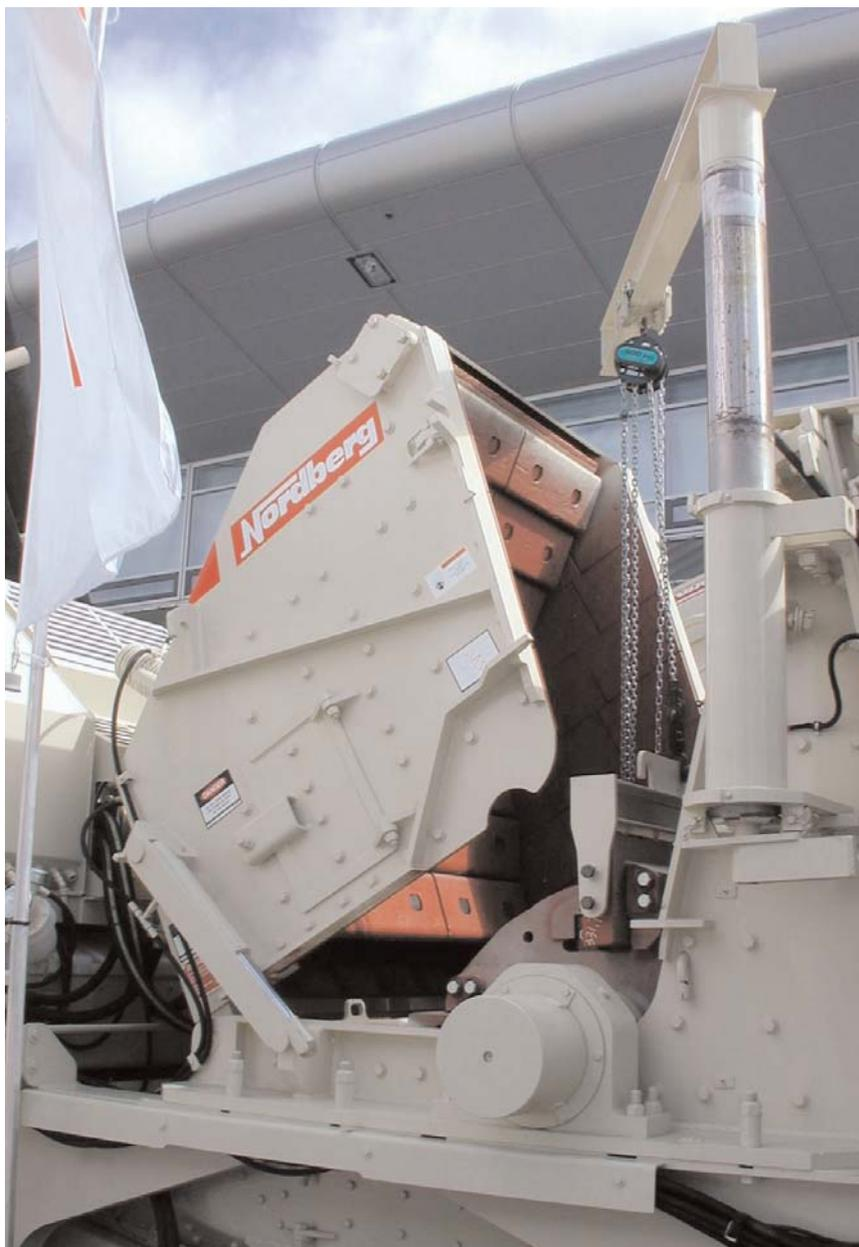
**Abb. 4: Montagekran für Wartungs- und Instandhaltungsarbeiten.**
