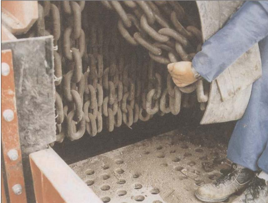
**Abb. 2: Kettenvorhang direkt am Prallbrechereinlauf.**
