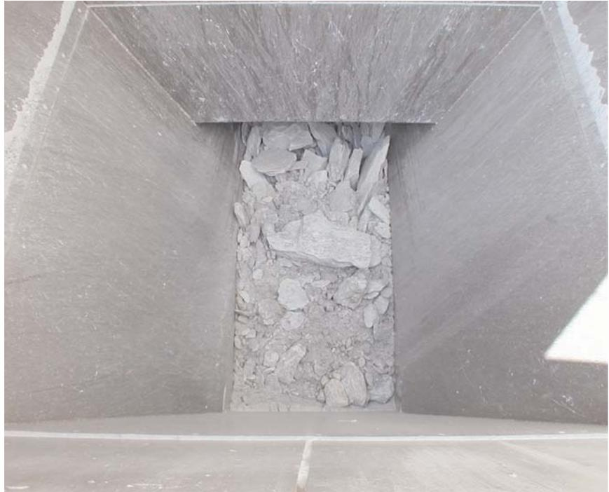
**Abb. 3: Schutzblech vor dem Prallbrechereinflauf.**
