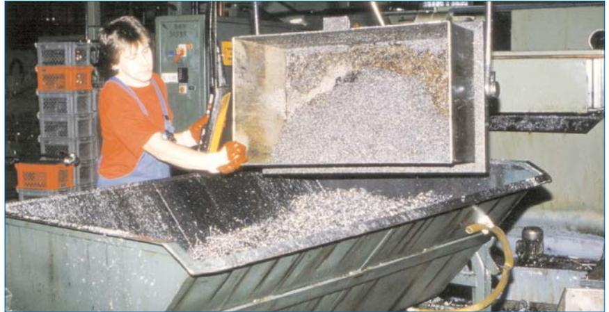
**Umfüllarbeiten von Spänen – Belastung durch Kühlschmierstoff-Nebel und -Dämpfe.**
