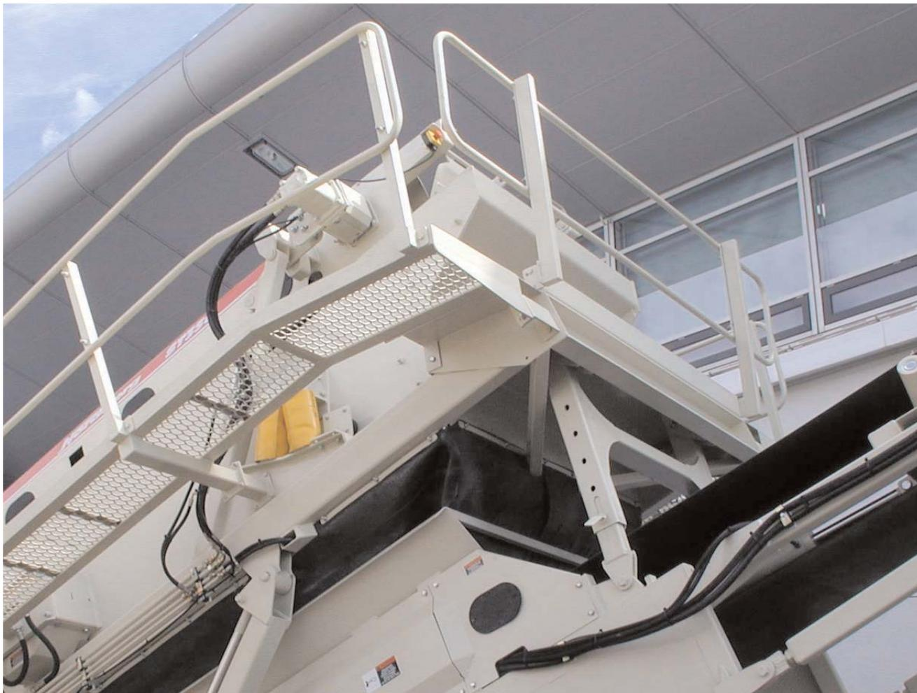
**Abb. 5: Gehweg am Austragsband eines mobilen Brechers mit Geländer und rutschhemmender Gehwegausführung.**
