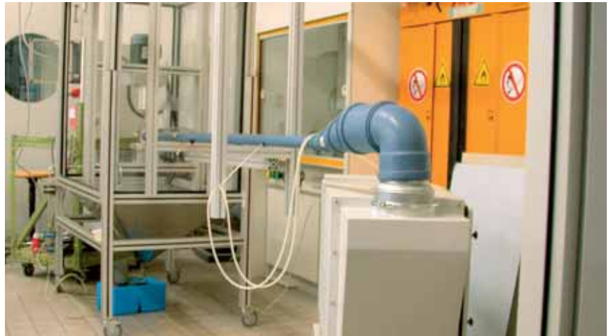
Abbildung 3: Aerosol Generator mit Absaugeinrichtung
