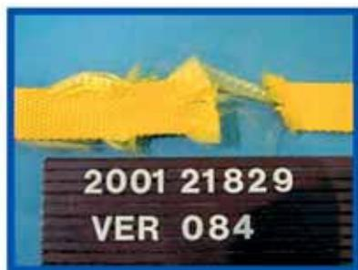
Abbildung 7: Gerissenes Verbindungsmittel (Gurtband)
