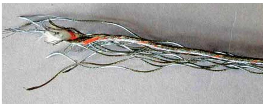
Abbildung 9: Beschädigtes Verbindungsmittel (Stahldrahtseil)
