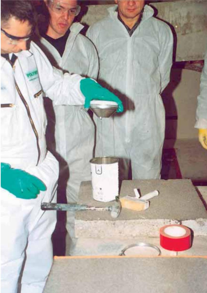
Abbildung 3: Zugabe des Härters aus einem durchstoßenen Kleingebinde
