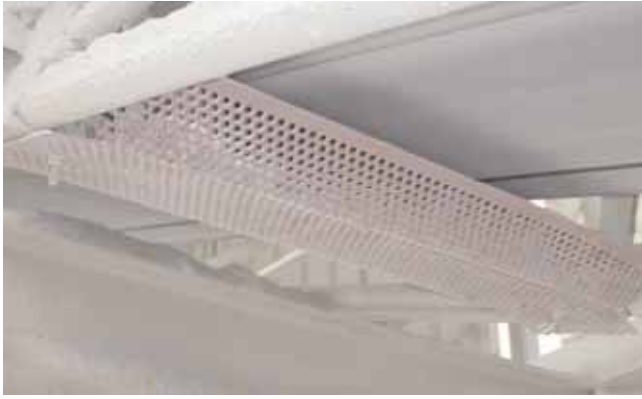
Abb. 1: Vollständige Verkleidung einer Untergurttragrolle mittels eines Schutzbleches
