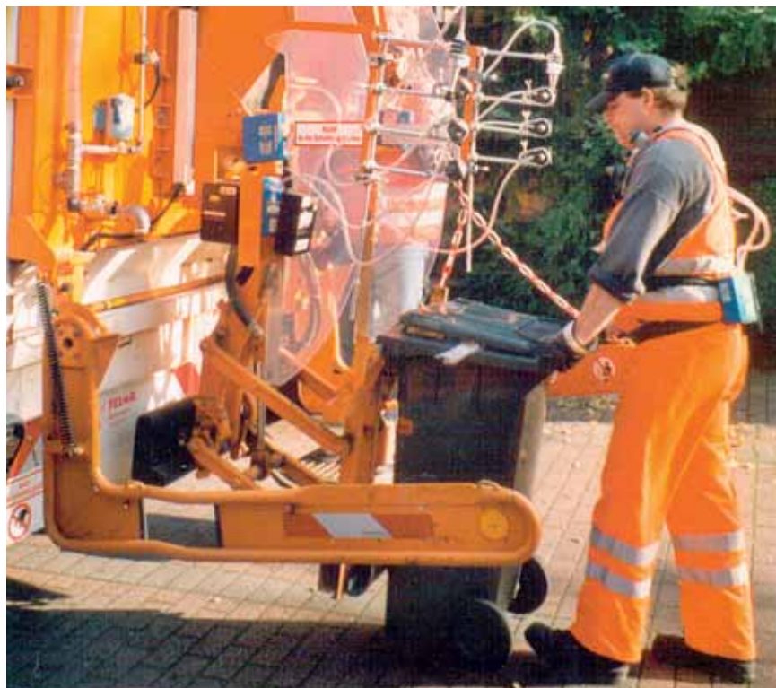
Bild 1: Messgeräteanordnung zur Durchführung der Bioaerosol- und Staubbmessungen
