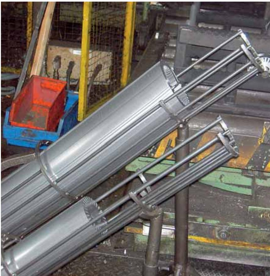
Austragsrohr als Stabkonstruktion
