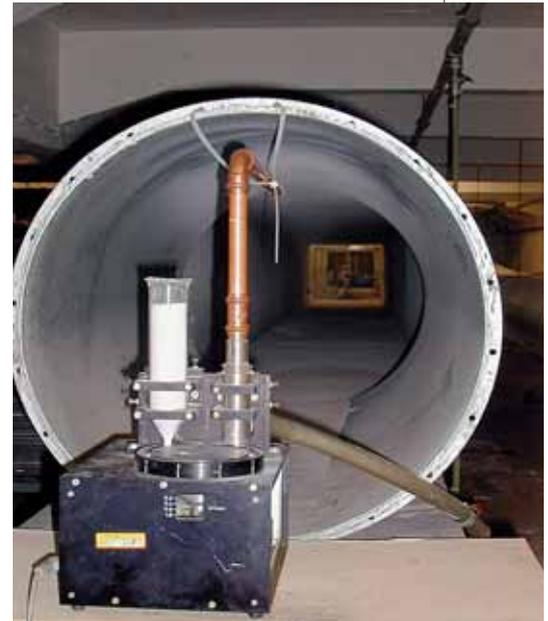
Abbildung 1: Aerosolgenerator
