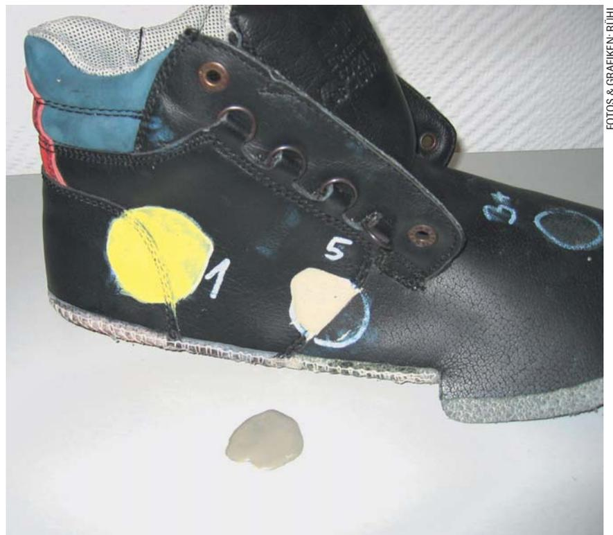
**Abbildung 3: Mit Reaktionsharz benetztes Schuhmaterial**
