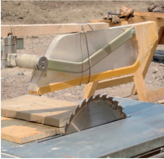
Abbildung 7: Kunstvoll, aber gefährlich und verboten: Schutzhaube B90 wurde hochgeklappt und mit Draht befestigt. Wenn die Schutzeinrichtung nicht verwendbar oder benutzerfreundlich ist, dann wird sie gegen Gefahr eingetauscht.
