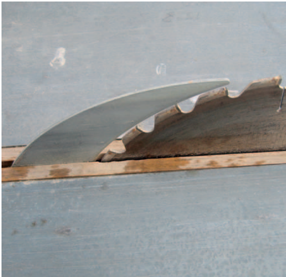
Abbildung 1: Detailaufnahme Baukreissägeblatt mit Spaltkeil.
