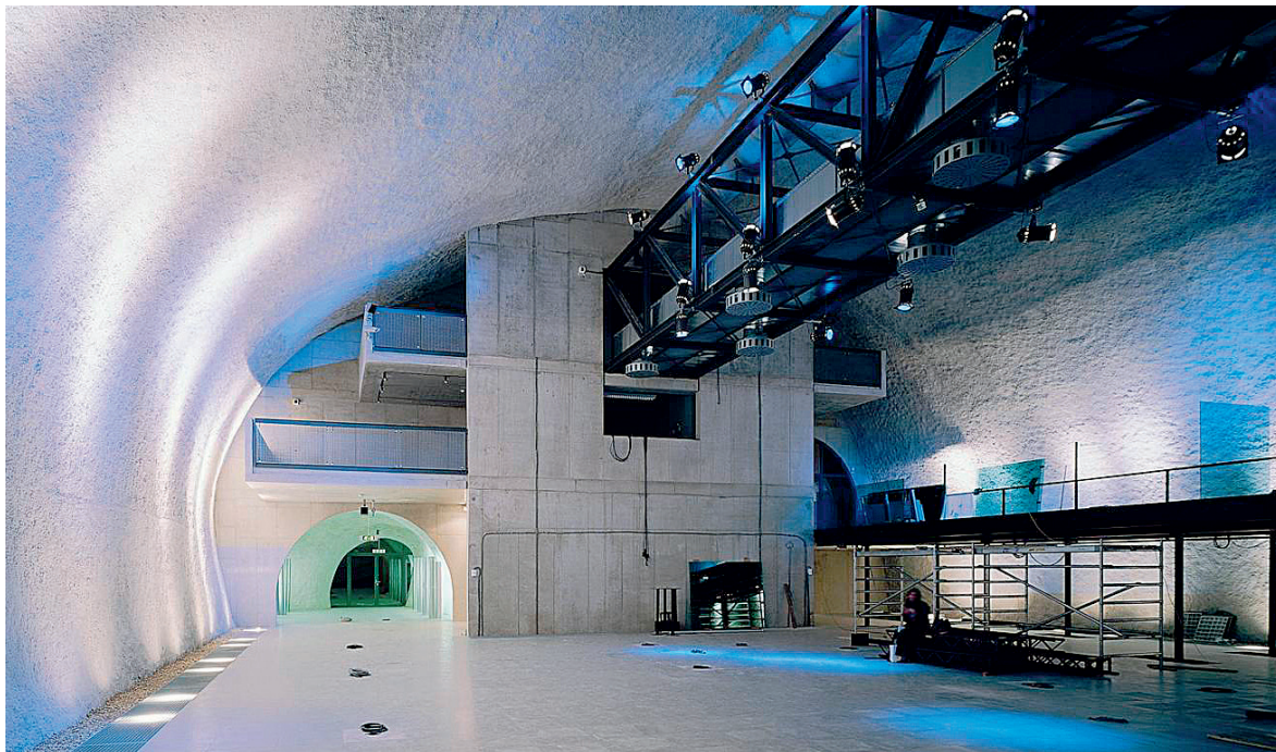
Ausgangssituation: Aufgesprühte Zelluloseschallabsorber, Veranstaltungshalle Dom im Berg/Graz
