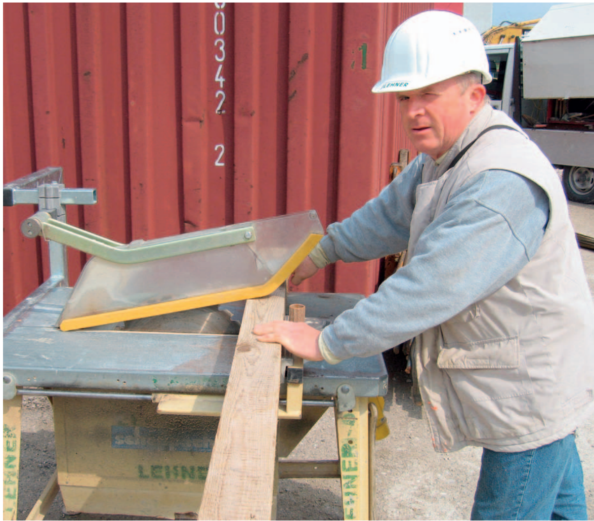
Abbildung 5: Die Schutzhaube B 90 wurde von Unfallverhütungsspezialisten der SUVA (Schweiz) und von Fachleuten der Baubranche entwickelt.
