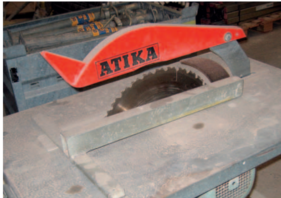
Abbildung 2: Eine Baukreissäge ist eine Tischkreissäge mit einem festen, auf einem Gestell befestigten Maschinentisch, bei der das Werkstück von Hand bzw. mit Schiebestock zugeführt wird. Zu den Schutzeinrichtungen gehören Schutzhaube, Spaltkeil, schallgedämpftes Sägeblatt, Parallelschlag, untere Blattverkleidung und Unterspannungsauslöser.
