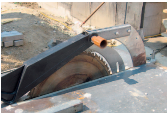
Abbildung 8: Baukreissäge auf einer Großbaustelle. Mit extra großer, ergonomisch geformter Schraubenmutter, damit man die störende Schutzhaube schnell komplett entfernen kann. Verboten!
