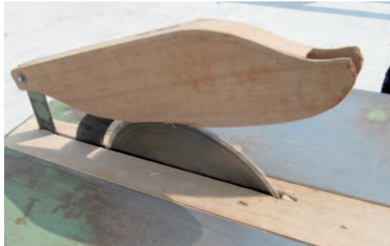
Abbildung 4: Ca. 25 Jahre alte traditionelle Baukreissäge mit rustikaler Schutzhaube aus Holz. Ob diese Schutzhaube allerdings so weit hinuntergesetzt werden kann, dass nur der zum Schneiden benutzte Teil des Sägeblattes frei bleibt, ist fraglich.
