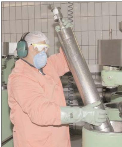
**Vorher:** Die Rotoren der Plasmazentrifugen (23 kg) müssen zur Reinigung händisch unter ungünstigen Bedingungen herausgehoben werden.
