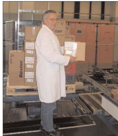
**Nachher: Günstigere Körperhaltungen beim Beladen durch Einbau eines Dreh-Hub-Elementes in die Rollenbahn.**
