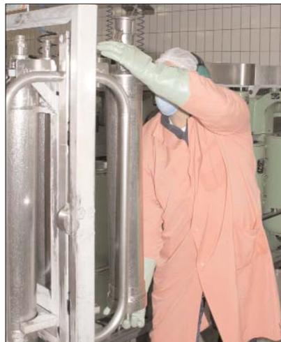
**Nachher:** Die Rotoren können mit Hilfe eines schwenkbaren Wagens herausgezogen und in günstiger Position gereinigt werden.
