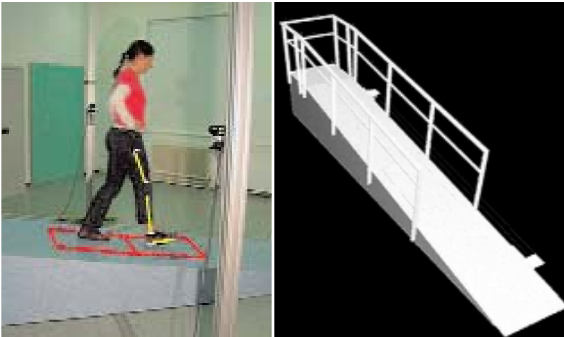
Abbildung 8: Abwärtsgehen eines Probanden über die beiden eingebauten Messplattformen, rechts: Schemaskizze der Messrampe
