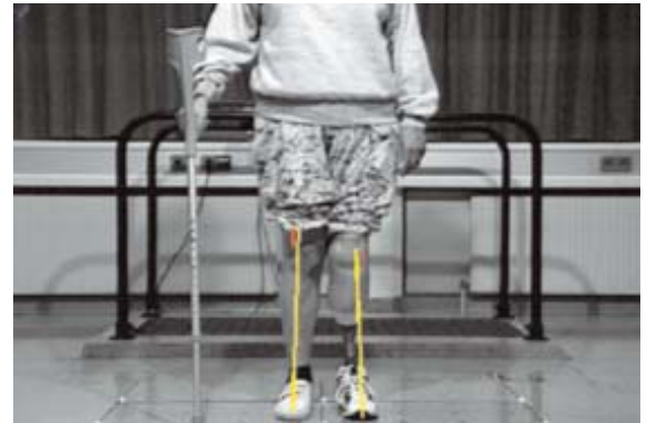
Abbildung 5: Kontrolle des statischen Aufbaus einer Prothese mit Hilfe des Videovektors (frontale Ansicht)
