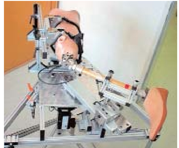
Abbildung 9: PROMEC mit eingespannter Oberschenkelprothese und polyzentrischem Kniegelenk
