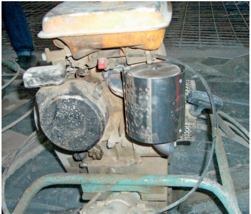
Abbildung 5: Katalysator am Einfachflügelglätter
