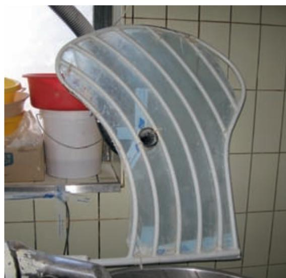
**Halboffene Abdeckung mit angeschlossener Absaugung beim Mischer**
