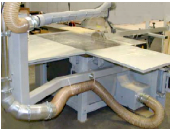
Staubtransport durch Schläuche und Förderleitungen an einer Formatkreissägemaschine
