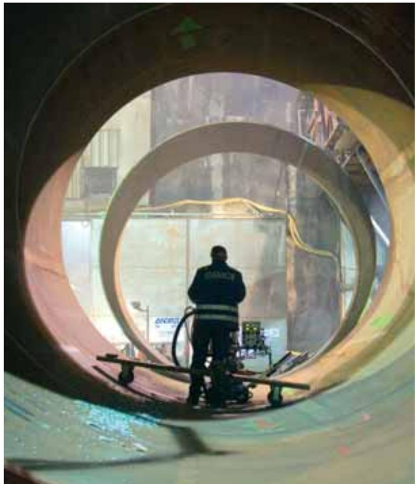
Rohrfertigung und Biegung direkt im Berg
