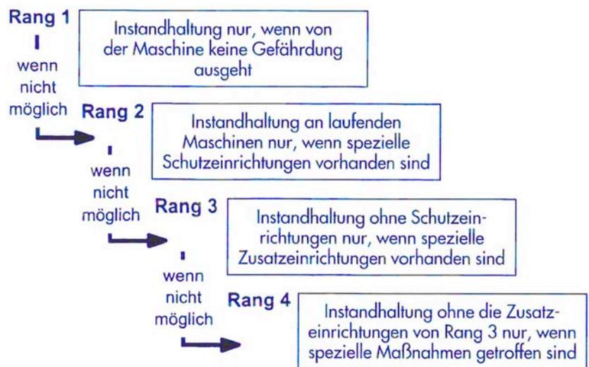
**Rang 1:** Mit Instandhaltungsarbeiten darf grundsätzlich erst begonnen werden, wenn von der Maschine keine Gefährdung ausgeht. Das ist dann der Fall, wenn
