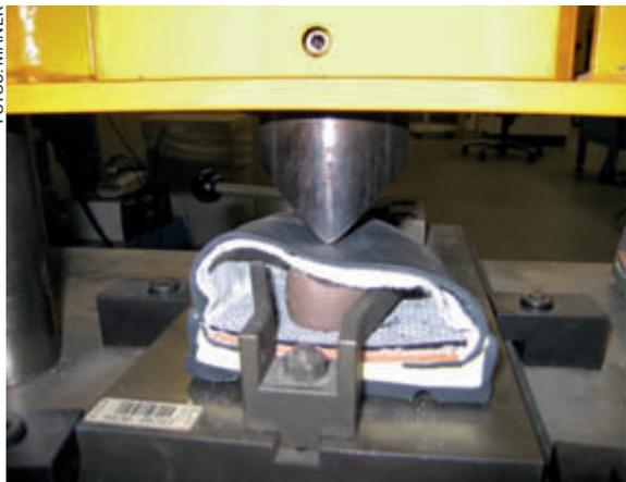
**Prüfung der Zehenschutzkappe auf Stoßbelastung: 20 kg aus einem Meter Höhe**
