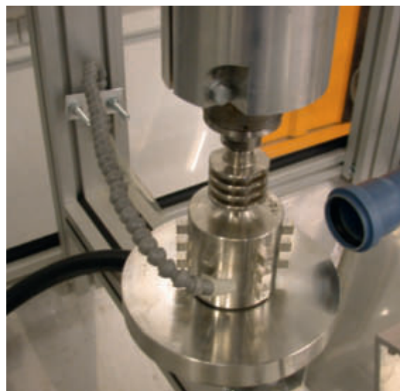
Der bezahnte und heizbare Rotor des Aerosolgenerators
