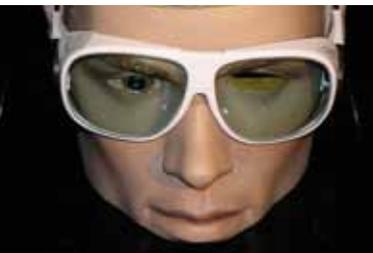
Die Laserschutzbrille von Laservision (roter Verlauf in Grafik 2) zeichnet sich durch einen transparenten, leicht grauen Schutzfilter aus Glas aus. Sie bietet zwar ausgezeichneten Infrarotschutz, ist allerdings auch sehr teuer.
