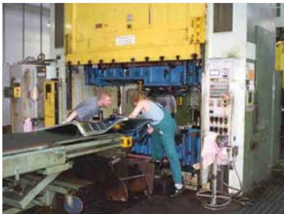
Bei Zwei-Personen-Bedienung ist bei Pressen der Taktbetrieb verboten
