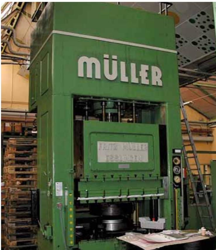
**B**ei der Verwendung von hydraulischen Pressen wird oft ein Lichtgitter als vorderseitige Absicherung verwendet. Diese Art der Absicherung ist sehr praktikabel, wenn die Bedienperson oft in den Werkzeugbereich muss, wie es zum Beispiel bei der Handeinlegung und Handentnahme der Fall ist. Nun müssen die Seitenbereiche und der hintere Bereich ohnehin abgesichert sein, und somit
