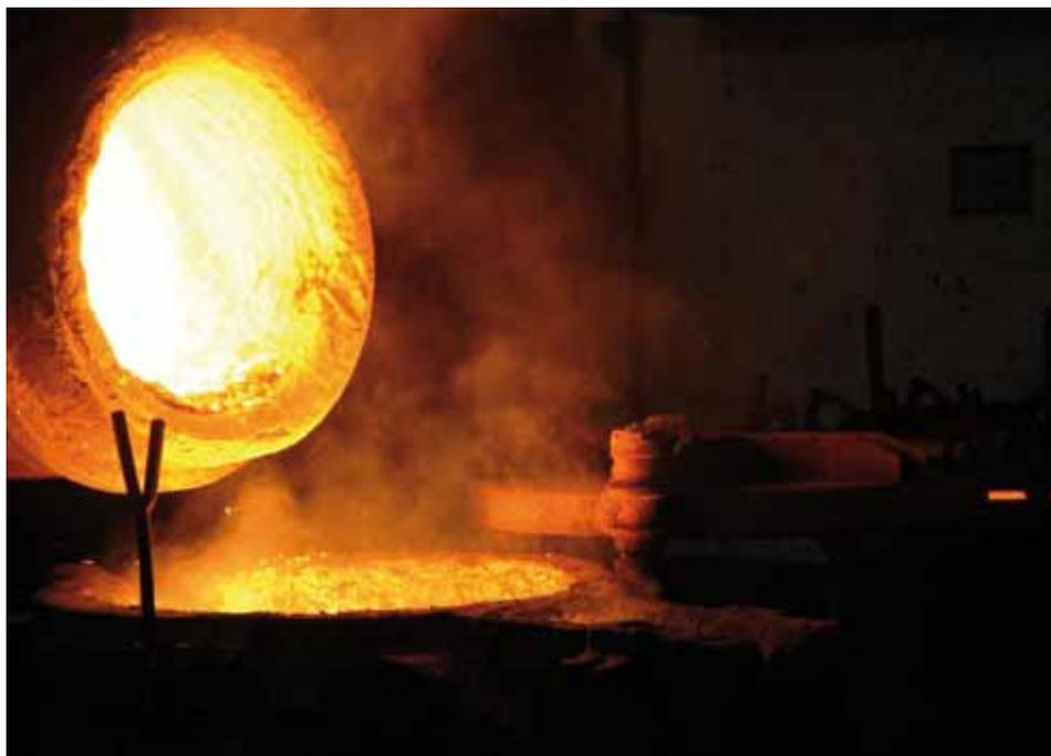
Abb. 1: Glühende Massen wie in einer Gießerei fallen in den Geltungsbereich der VOPST. Sie emittieren vor allem IR-Strahlung
