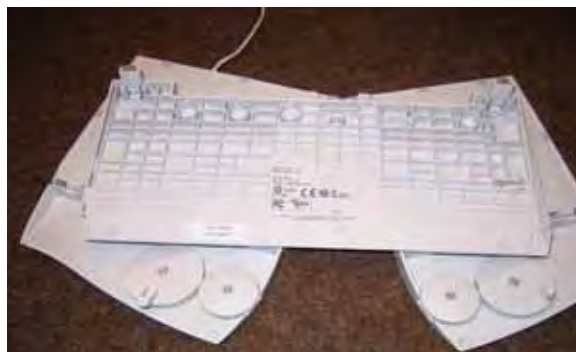
Sehr komplexe Verstellmechanismen unter der Tastatur zum Höherstellen und Auseinanderklappen. Dieses Modell ist angenehmer als eine normale Tastatur, zusammengeklappt und flach. Leider fehlt hier der Nummernblock.
