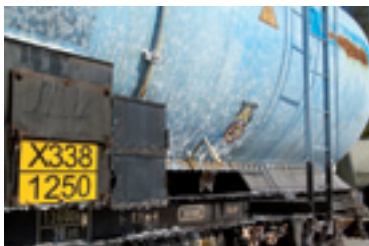
Ein geeigneter Keil verringert den weiteren Produktaustritt
