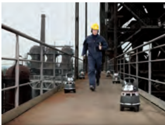
Das Gasmesssystem Dräger X-Zone 5000 erweitert die mobile Gasmess-technologie zu einem System mit vielen flexiblen Einsatzmöglichkeiten
