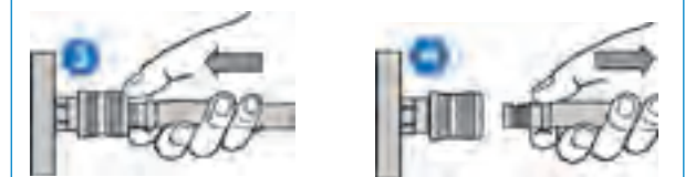
Freigabe des Nippels erst nach Druckentlastung und neuerlichem Betätigen der Verriegelungshülse
