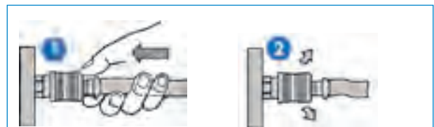
Sichere Druckentlastung auf unter 2 bar
