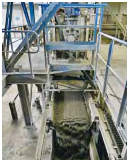
Der Baustoff Prottelith Leichtbeton wird nach einem patentierten Verfahren aus zementummanteltem EPS-Recyclinggranulat produziert.
