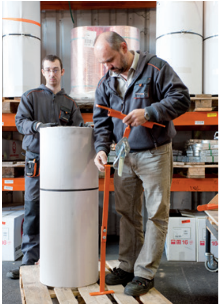
Gefahr gebannt: Mit dem „Coilhalter System KW“ können Blechrollen sicher gelagert und transportiert werden.
