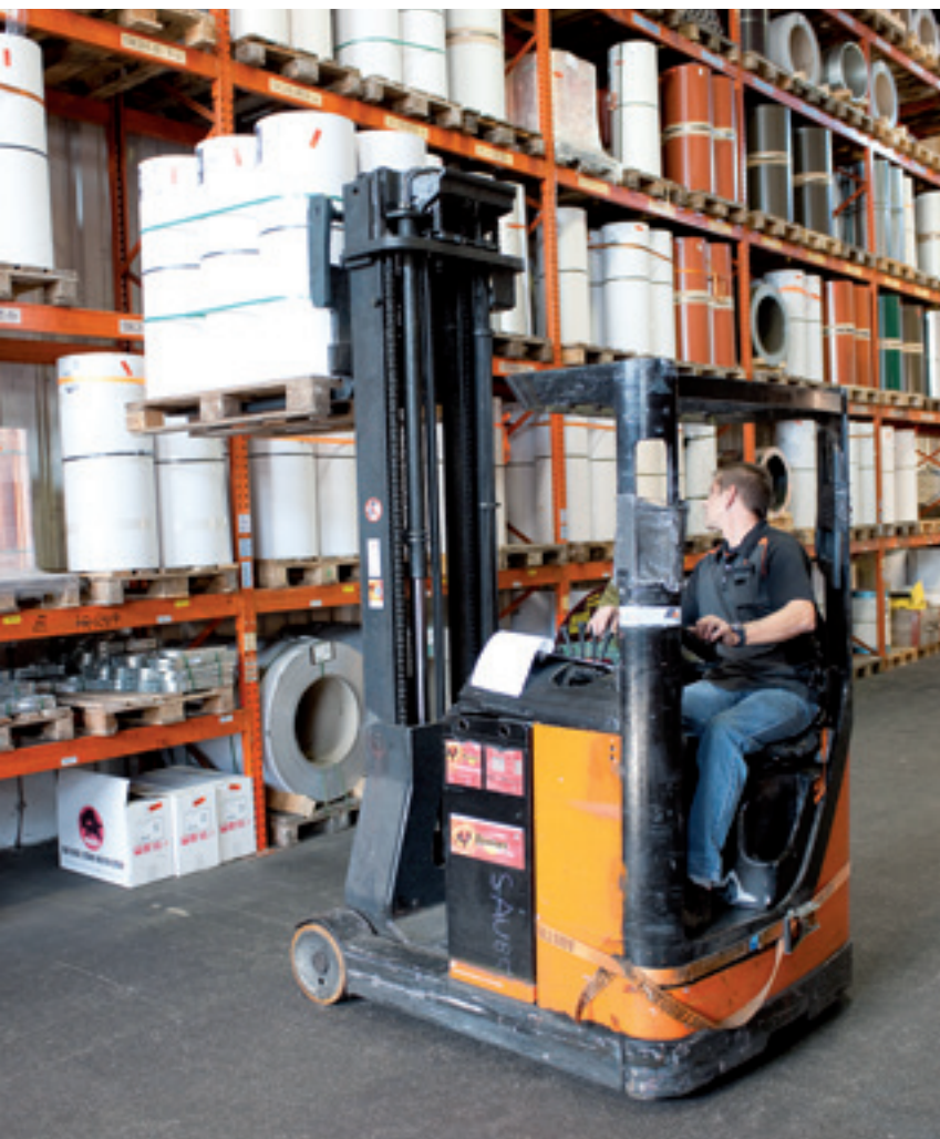
Die Blechrollen sind durch Kraftschluss fest mit der Palette verbunden.
