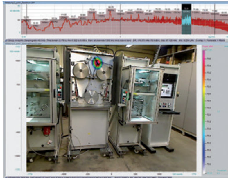
Beispiel einer Spulabwickelmaschine mit Frequenzanalyse (Medek & Schörner GmbH): Im Bereich um die 5.000 Hz ist das Maximum anhand der roten Markierung ersichtlich. Der obere Teil des Bildes macht das gesamte Frequenzspektrum der Anlage ersichtlich – markiert ist jener Bereich, für den der Farbverlauf im Bild dargestellt ist
