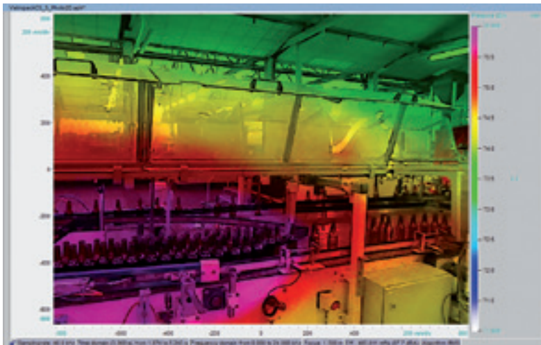
Zwei akustische Fotos eines Förderbandes mit Glasflaschen (Fa. Vetropack): Auf der oberen Abbildung ist die Situation bei offener Abdeckung dargestellt, auf dem unteren Foto jene bei geschlossener Abdeckung. Die akustische Wirkung der Abdeckung ist deutlich erkennbar
