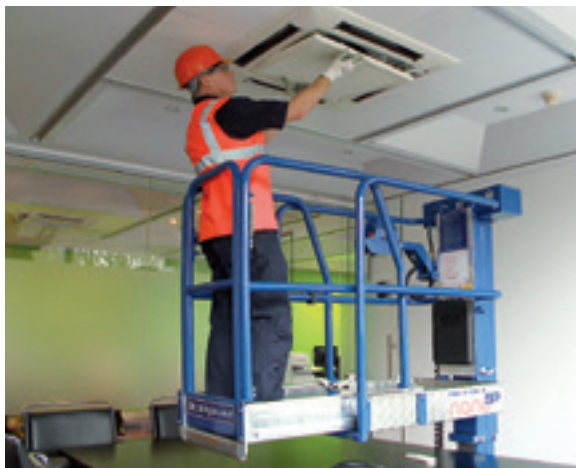
Der Benutzer schiebt das Gerät an den Arbeitsort, betritt die Plattform und hebt sie per Knopfdruck bis zur gewünschten Arbeitshöhe an.
