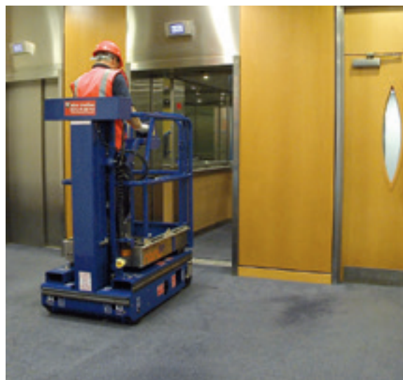
Dank geringer Abmessungen passen die Hubarbeitsbühnen durch jede Normtür und in Personenaufzüge.
