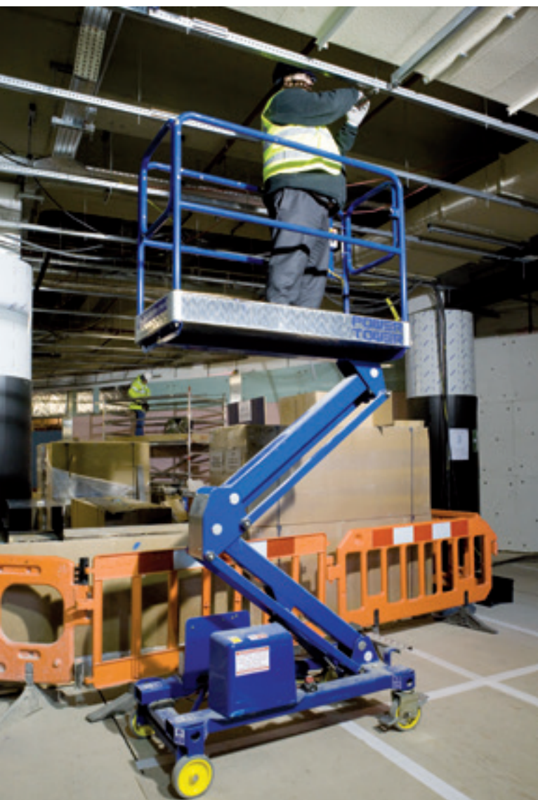
Handverschiebbare Hubarbeitsbühne: Kombination aus einem einfachen Hebe- mechanismus und einem vollständig geschützten Arbeitskorb
