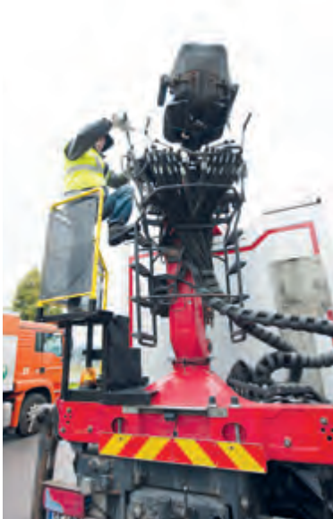
Ein speziell entwickelter Stiegenaufgang ermöglicht dem Fahrer den bequemen und vor allem sicheren Auf- und Abstieg zu seinem Arbeitsplatz am Kranhochsitz in vier Metern Höhe.
