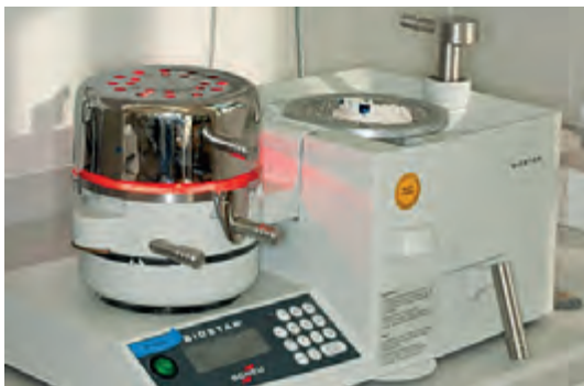
Thermoapparat zur Herstellung des Mundschutzes
