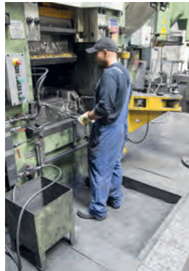
Anpassung des Bodens an die Größe des Mitarbeiters und an die für die Arbeitstätigkeit passende Höhe einer sehr großen Presse, damit körpergerechtes Arbeiten immer möglich bleibt
