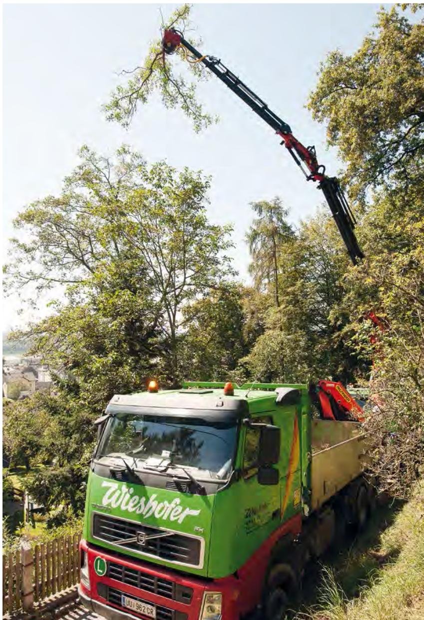
Bäume bis zu einer Höhe von 32 Metern können mit dem fernbedienten Schneidkopf am Kran sicher abgetragen werden.
