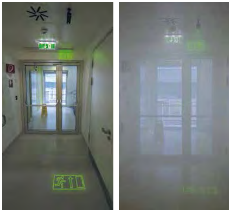
Das Laser-Orientations-Modul in der praktischen Anwendung: unter normalen Bedingungen (linkes Bild), in einer simulierten Brandsituation mit Rauchentwicklung (rechtes Bild)
