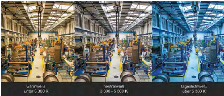
Foto 5: Dieselbe Halle bei Beleuchtung in unterschiedlichen Lichtfarben
