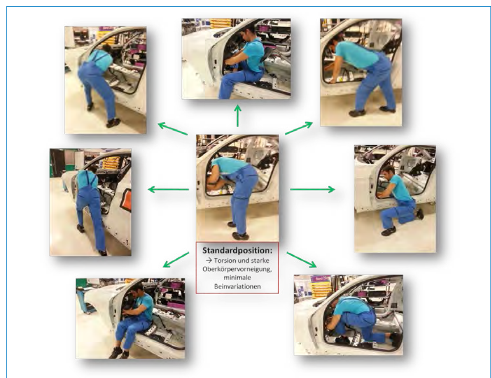
Abb. 2: Beispiel für einen Belastungsmix durch eine „Innere Rotation“ in einem Arbeitstakt – Rumpffentlastung durch Beinvariationen und vielseitige Körperpositionierung zum Fahrzeug
