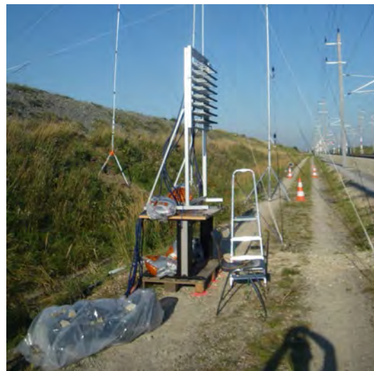
Mikrofonarray für Messungen der Schallabstrahlung von Zügen und einzelne Mikrophone für die Bestimmung der Schalleistung.
