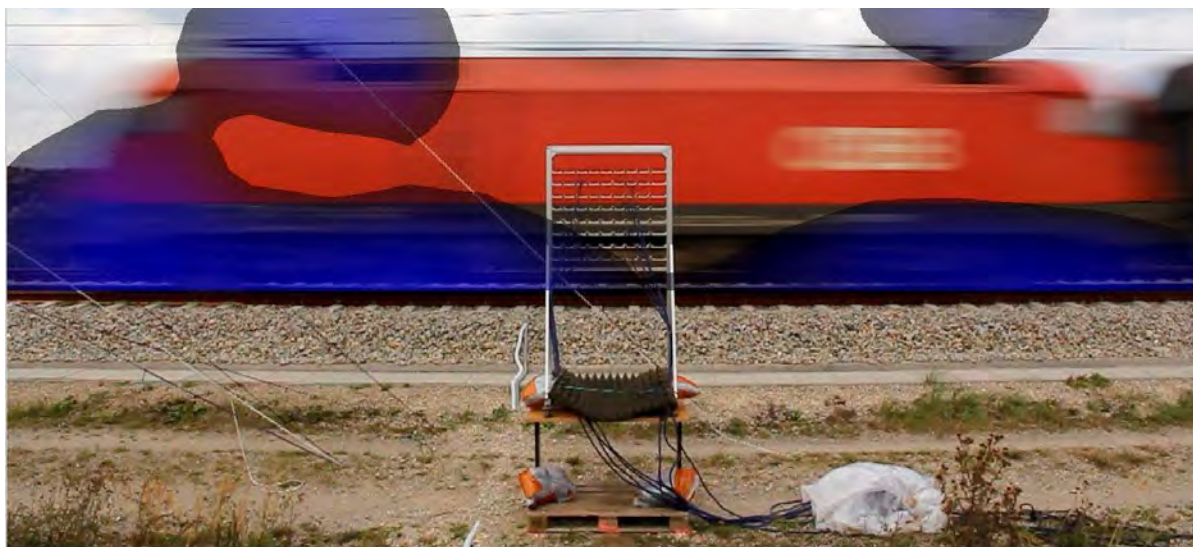
Schalldruckverteilung auf einem Taurus Triebfahrzeug. Blaue Flächen sind Bereiche höherer Schallintensität. In der Abbildung werden lautere Stellen durch dunkleres Blau gekennzeichnet. Es kann leicht erkannt werden, dass bei einem Zug die primären Schallquellen vom Rad-Schiene-Kontakt und teilweise auch von den Verwirbelungen am Stromabnehmer gespeist werden.
