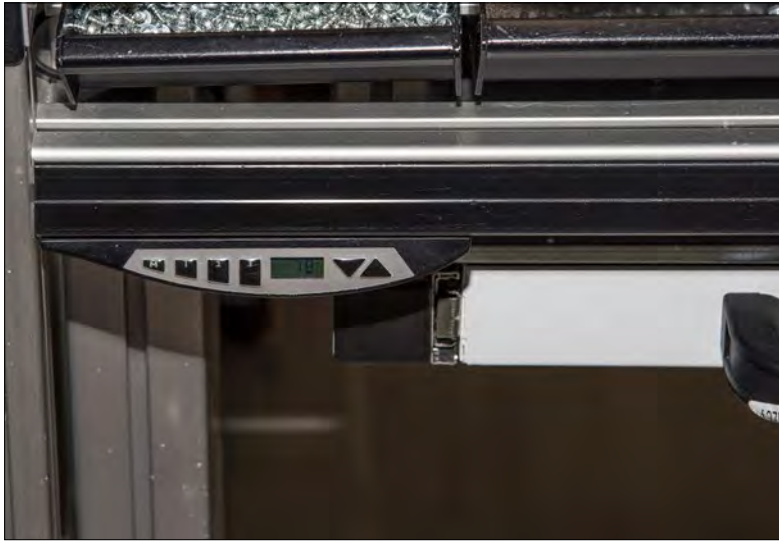
Detailaufnahme einer elektrischen Höhenverstellung bei den Arbeitsplätzen in der Produktion
