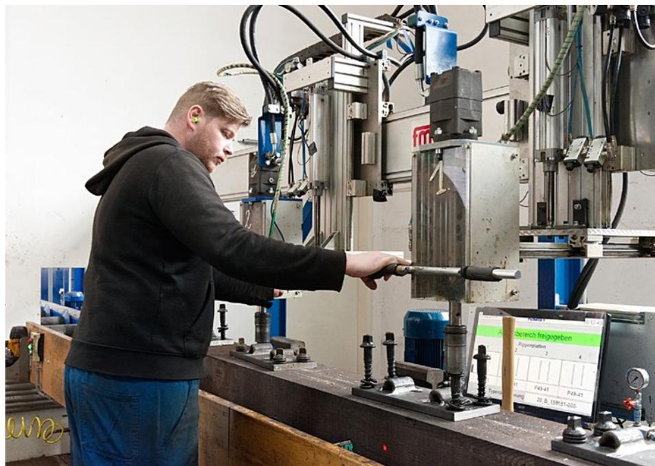
Befestigen der zuvor angesetzten Schrauben mit einer hydraulischen Eindrehmaschine. Der Vorgang ist vibrationsfrei, geräuscharm und drehmomentüberwacht.
