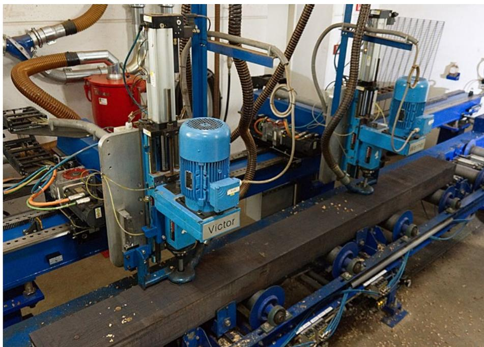
Koordinatenbohrmaschine mit zwei unabhängigen Bohreinheiten und direkter Absaugung am Bohrer.
