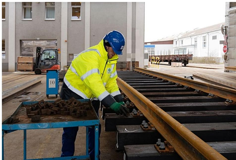
Montage der Schienen, Backenschienen und Zungen auf die im Aufplattzentrum vorbereiteten Schwellen.
