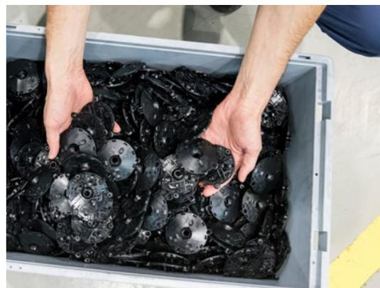
Im Spritzgussverfahren werden bei Magna Auteca aus POM-Rohgranulat Teile hergestellt, die in Seitenspiegeln von Autos verbaut werden.
