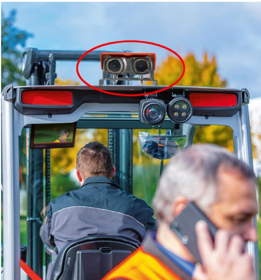
**Blaxtair® ist das branchenführend bei eingebetteten Detektionssystemen für die Industrie. Eine innovative 3D-Kamera erkennt Hindernisse in der Nähe von Baufahrzeugen oder im Logistikverkehr. Sie unterscheidet dank künstlicher Intelligenz einen im Aktionsradius des Fahrzeugs befindlichen Menschen von einem anderen Hindernis und vermeidet so Unfälle.**
