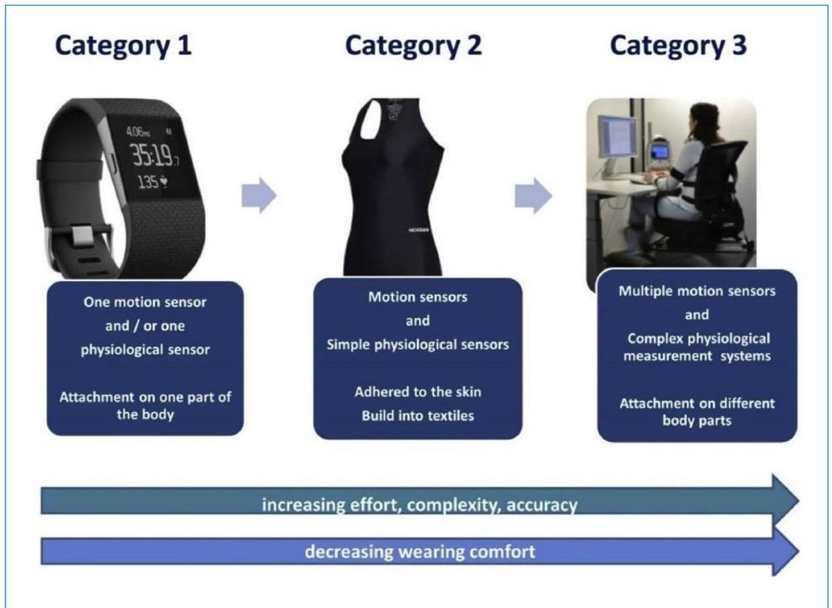
Kategorisierung von Wearables basierend auf Art und Anzahl der verwendeten Sensoren, der Anbringung der Sensoren am Körper und der Genauigkeit und Komplexität der bewerteten und bereitgestellten Daten.
