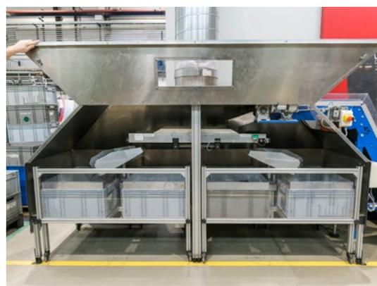
Bei Magna Auteca reduziert eine Absauglösung direkt an der Auswurfseite der Maschine und über den Sammelboxen mit noch heißen Formteilen die Formaldehyd-Dämpfe.
