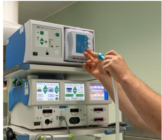
An der Filterkartusche wird der Absaugschlauch angeschlossen. Die Kartusche kann entnommen und getauscht werden.
