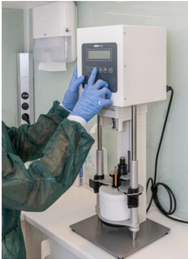
Vollautomatische Rührsysteme verringern die Freisetzung von Stäuben und Dämpfen bei der Mischung von Salben, Cremes oder Pasten.
