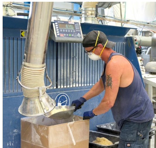
Die Wiegestation ist mit einem Absaugpaneel und einem zusätzlichen Absaugarm ausgestattet.
