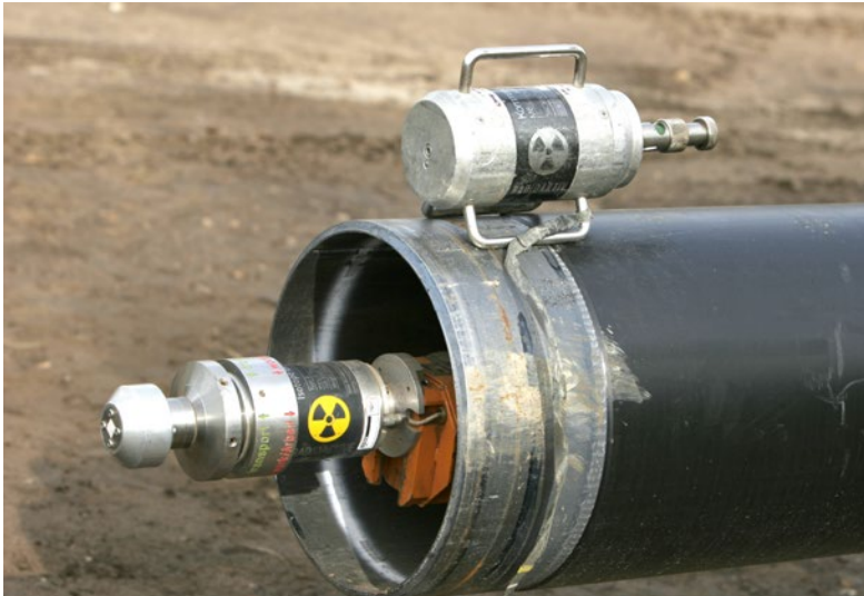
Ein Rohrmolch wird zur Schweißnahtprüfung ins Rohr eingefahren. Dieses Gerät benötigt in Zukunft eine Einzelbewilligung zur Ausübung der Tätigkeit.
