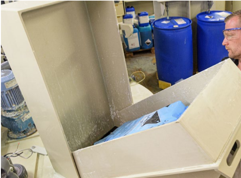
Durch die eigens angefertigte geschlossene Sackdosieranlage wird Staubentwicklung vermieden.
