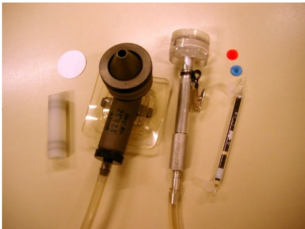
Abbildung 1: Vergleich der Messvorrichtungen Linke Seite: XAD-Kartusche und Glasfaserfilter mit Messkopf IFA / SUVA Rechte Seite: Messkopf AUVA mit Glasfaserfilter und Aktivkohleröhrchen
