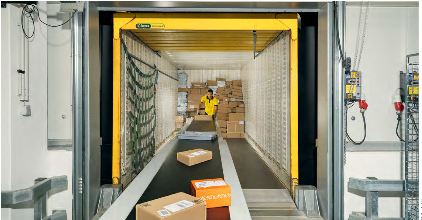
Mit dem „Rapid Unloader“ werden bei der Post Belastungen des Bewegungsapparates minimiert.
