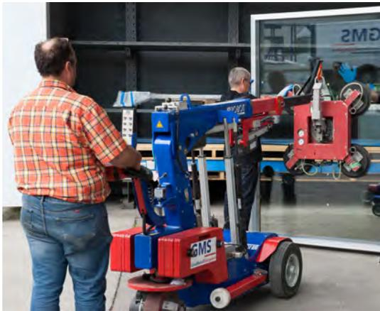
Ein umgebauter Glasroboter ermöglicht die körperchonendere Fenstermontage.
