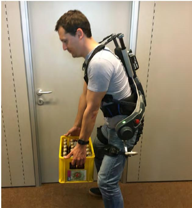
Aktives, mit Elektromotor angetriebenes Exoskelett.
