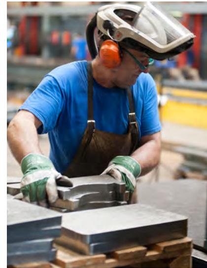
Höhenverstellbare fahrbare Paletten erleichtern bei Wagner das Schichten der Teile.
