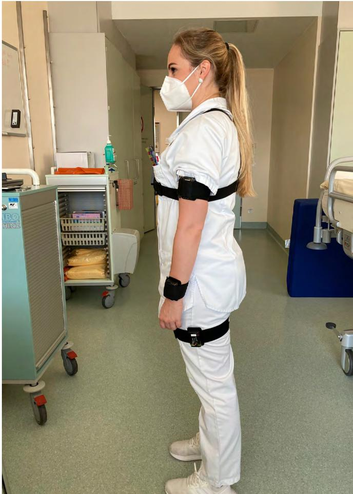
Alle Sensoren sind kabellos, haben die Größe einer Zündholzschachtel und werden lediglich mittels Manschetten über (im Bild) oder unter der Kleidung angebracht.
