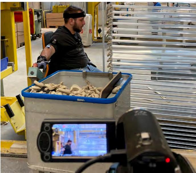
Das System „Captiv“ besteht aus einer Vielzahl von Sensoren zur Erfassung physiologischer Parameter, die mit Video synchronisiert werden und im Weiteren detailliert ausgewertet und interpretiert werden können.
