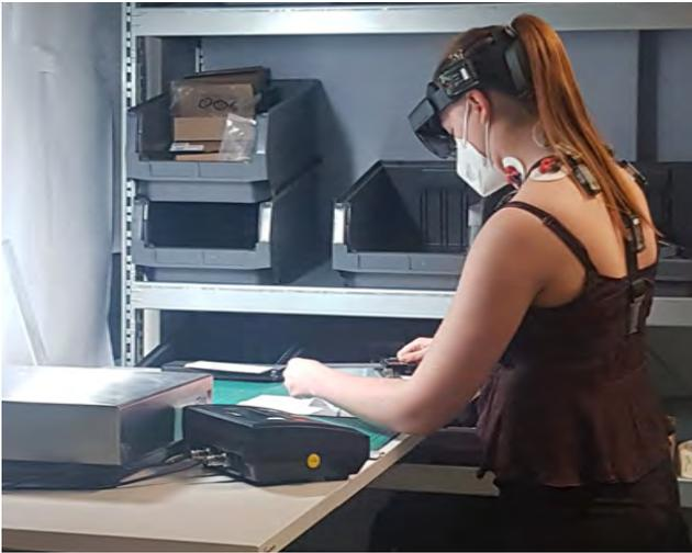
Die Arbeitsschritte an der Werkbank. Die Userin trägt eine HoloLens 1, an Nacken und Hals sind EMG-Sensoren des Captiv-Systems aufgeklebt.
