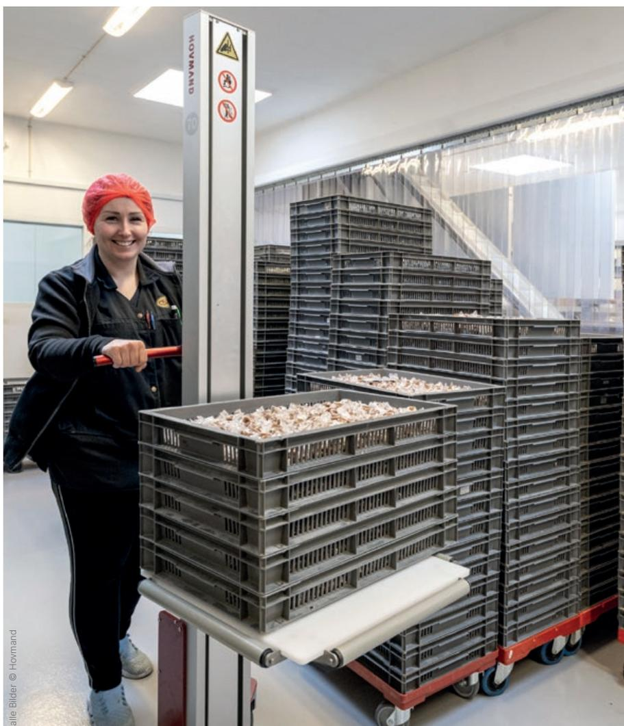
Ergonomisch und effizient: Mit den Hebelösungen von Hovmand werden mehrere Verpackungskisten von einer Person allein transportiert, ohne dass diese schwer heben muss.
