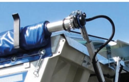
Dank Elektromotor lässt sich die Rollplane auf Knopfdruck vom Boden aus öffnen und schließen, ohne dass der:die Fahrer:in auf das Stirnwandplateau des Kipp- und Muldenfahrzeugs steigen muss. Drei Luftschläuche zwischen Dachplane und Dachquerspiegel des Lkw (hier in der Innenansicht) verhindern Wasseransammlungen und Eisbildung am Dach bzw. helfen, Eisplatten aufzubrechen.
