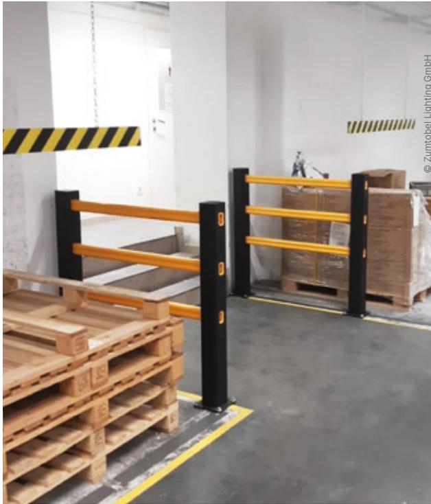
Bei Zumtobel setzt man auf Barrieren aus flexiblem Spezialkunststoff als Anprallschutz und Abgrenzung.
