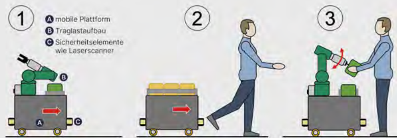
Abb. 2: Flexibler Einsatz autonomer mobiler Roboter
