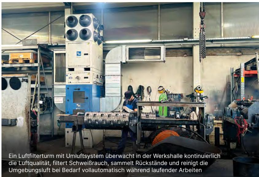
Ein Luftfilterturm mit Umluftsystem überwacht in der Werkshalle kontinuierlich die Luftqualität, filtert Schweißrauch, sammelt Rückstände und reinigt die Umgebungsluft bei Bedarf vollautomatisch während laufender Arbeiten
