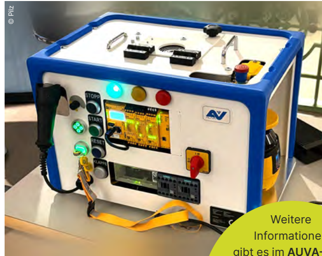
Praxisnahe Kurse mit dem „Maschinensicherheitswürfel“ ermöglichen das Erproben von Laserscanner-, Lichtgitter- und Radarsystemen. Ein Prototyp dient bereits als Anschauungs- und Trainingsmodell für Kunden:Kundinnen
