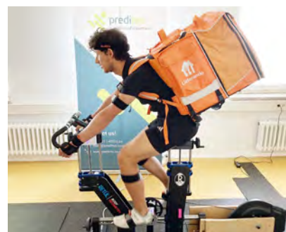
Proband bei der Untersuchung auf einem Fahrrad-Ergometer, ausgestattet mit Beschleunigungssensoren
