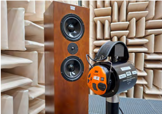
Akustische Prüfvorrichtung mit Kapselgehörschutz
