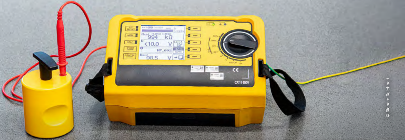
Messanordnung zur Messung des elektrischen Widerstands gegen Erde von verlegten Fußböden: Hochohmmeter mit angeschlossener Erdung und einer Messelektrode (Gewicht ca. 2,5 kg)
