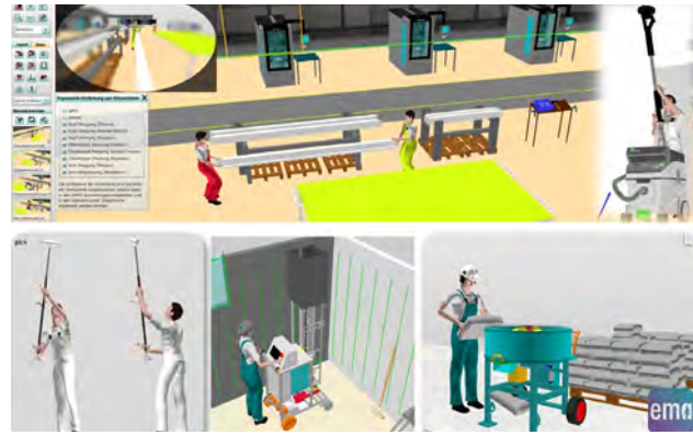
Abbildung 6: Einsatz von ema im Bauwesen – oben: Vorfertigung; unten: Ausführung auf der Baustelle
