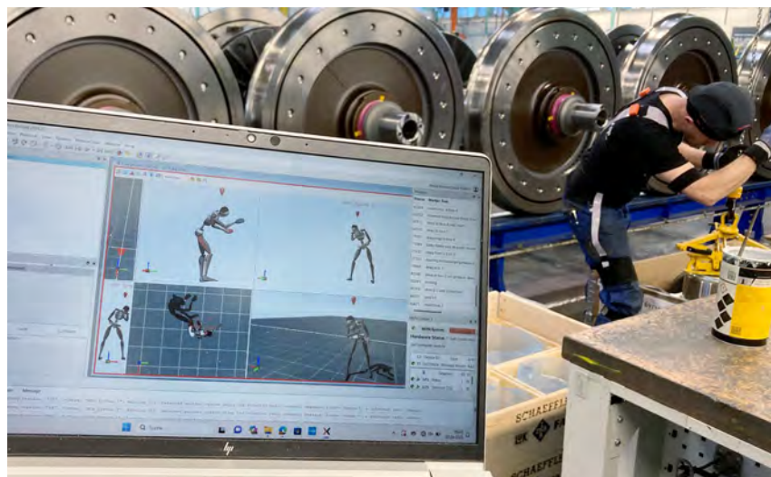
Erfassung der Körperhaltung mit sensorbasierter Bewegungsanalyse – Darstellung als Avatare
